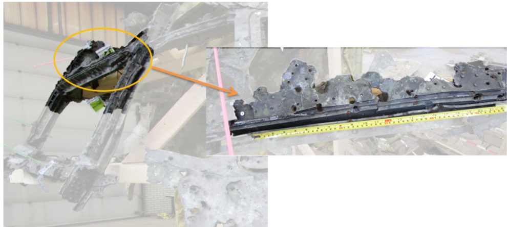
Figuur 3.5: Raamstijl links midden AAHZ3544NL met uitvergroot detail (bron: TNO). De perforatie schade heeft een regelmatig patroon van grotere en kleinere gaten. Dit wijst op een gevechtsslading met verschillende fragmentvormen.
