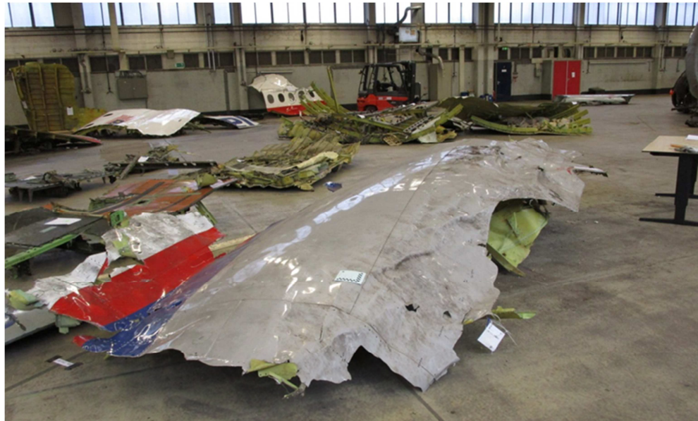
Figuur 3.8: Paneel AAHZ3258NL zonder waarneembare blast schade (bron: TNO). Dit paneel stelt een grens aan het blast schadegebied. Het paneel is wel beschadigd door het opbreken van het vliegtuig en de inslag op de grond.
