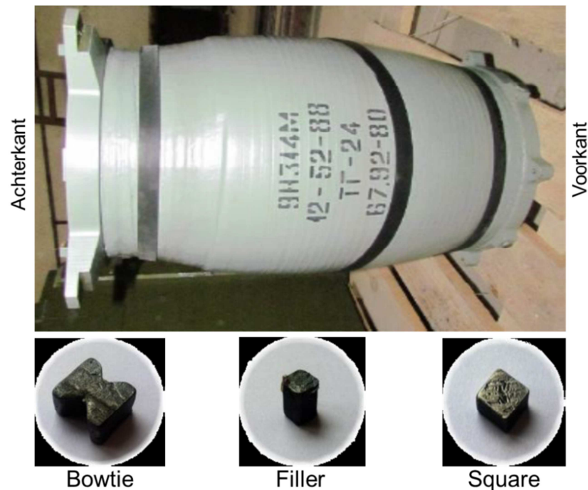
Figuur 4.3: Aanzicht van gevechtslading 9N314M (cyrillische H is gelijk aan N) met onder de verschillende fragmentvormen die deze bevat ( bowtie , filler , square ). Bron: [5].
