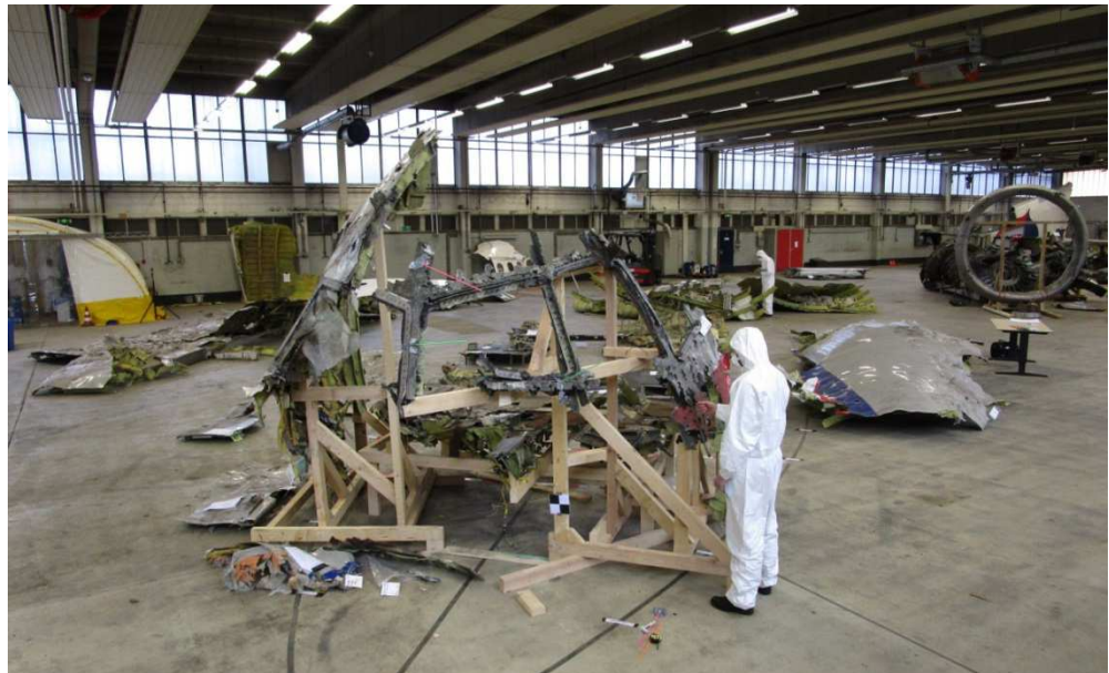
Figuur 3.1: Reconstructie van de MH17 aan de hand van geborgen delen van het vliegtuig (bron: TNO). Op de voorgrond is zichtbaar de cockpit en rechtsachter de inlaat van de linker motor. De relatieve hoogte van de verschillende delen is niet waarheidsgetrouw.
