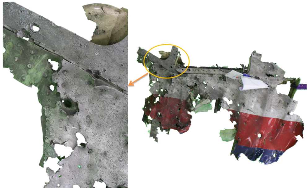
Figuur 3.4: Cockpit paneel links AAHZ3163NL met uitvergroot detail (bron: OVV). De perforatieschade heeft een regelmatig patroon van grotere en kleinere gaten. De huidbeplating is verder beschadigd door pitting , wat kan zijn veroorzaakt door de inslag van vele kleine hete deeltjes, zoals kruitresten en gesmolten metaal. De pitting schade is plaatselijk; naburige panelen hebben geen schade door pitting .
