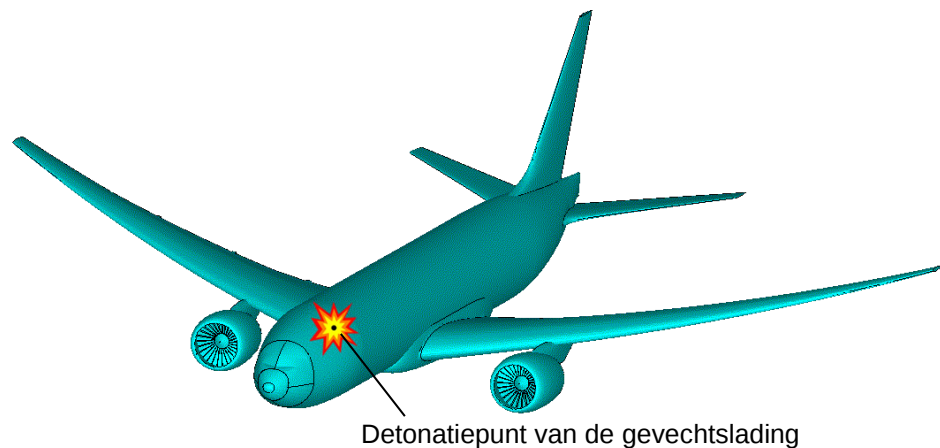
Figuur 2.4 Op het moment van detonatie bevindt de gevechtsslading zich ten opzichte van het vliegtuig dicht bij de linkerzijde van de romp en vlak bij de cockpit.
