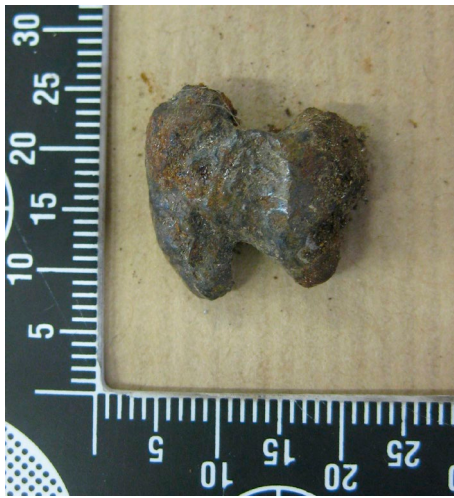
Figuur 46: Vliedervormig fragment gevonden in de wrakstukken van de cockpit, grootte in mm (Bron: OVV)
