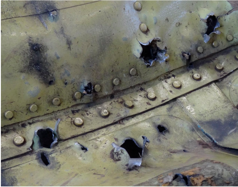
Figuur 8: Plaatmateriaal naar binnen gebogen. Gezien vanaf de binnenkant van de constructie
