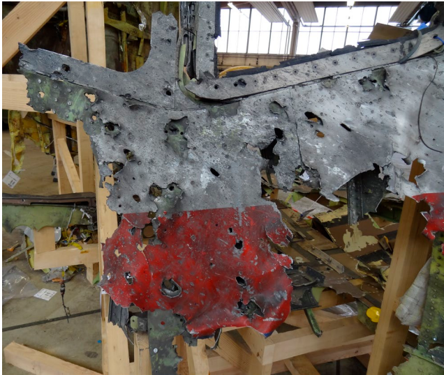
Figuur 12: Wrakstuk gebruikt voor de meting van de grootte van de doorboringsschade
