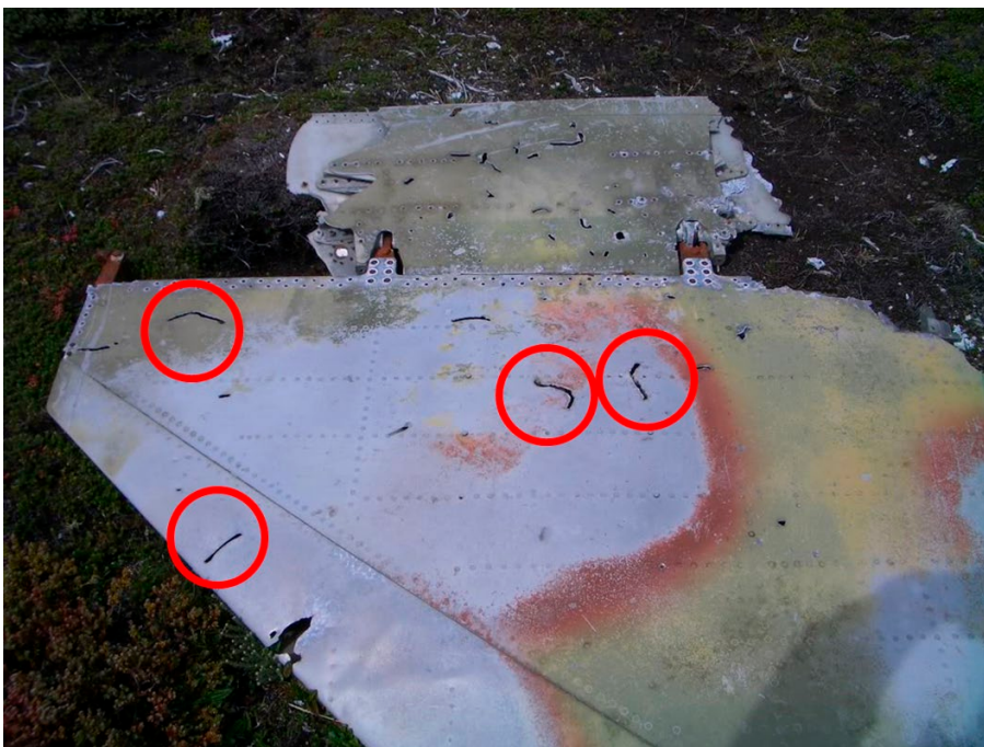
Figuur 44: Schade van losse staven (discrete rod) (Bron: PPRuNe.org )
