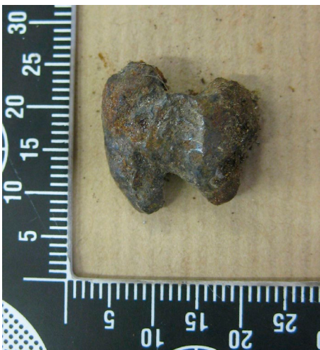
Figuur 32: Vlindervormig fragment gevonden in de wrakstukken van de cockpit, grootte in mm (Bron: OVV)
