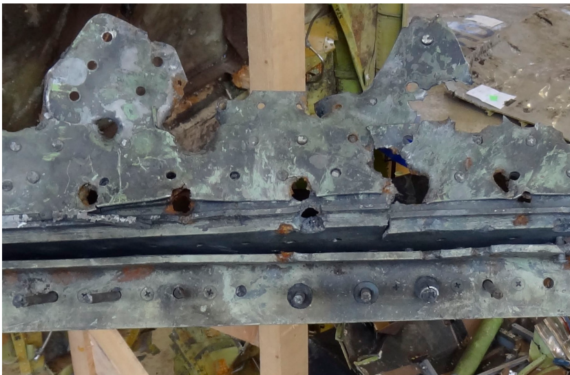
Figuur 15: Regelmaat van treffers op de bovenste raamstijl van de cockpit
