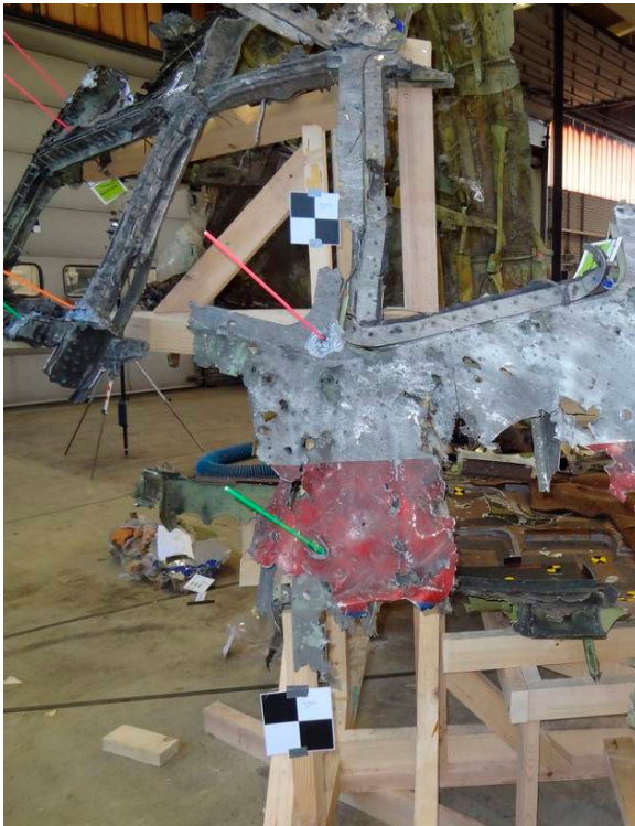
Figuur 23: Inslagrichting van de hoogenergetische objecten
