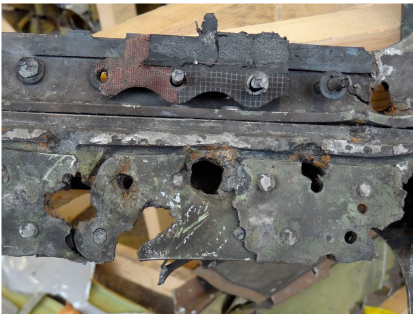
Figuur 16: Regelmaat van treffers op de onderste raamstijl van de cockpit
