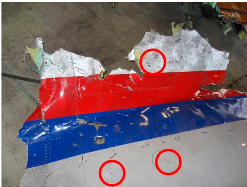
Figuur 21: Linkerpaneel met schampschade door afketsing
