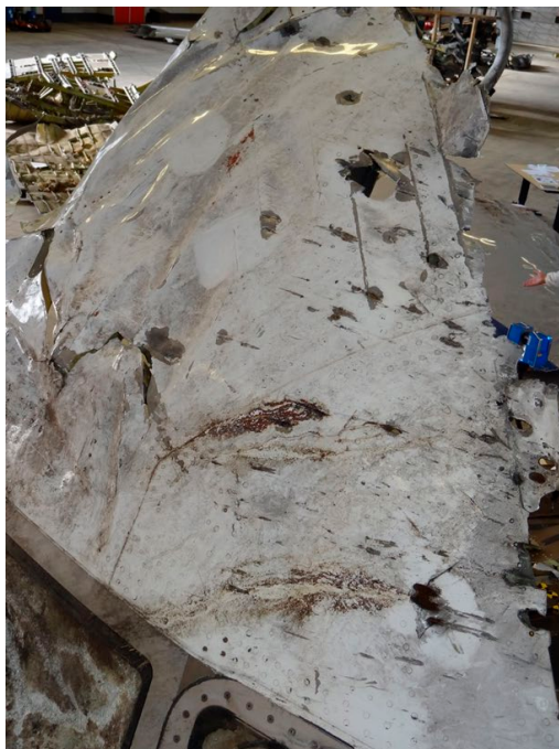
Figuur 56: Match van inslagen van de hoogenergetische objecten op het cockpit-dak
