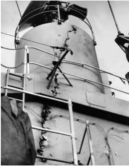
Figuur 43: Schade door de springkop met metalen staven van AIM-7 Sparrow (continuous rod) (Bron: navalofficer.com.au )
