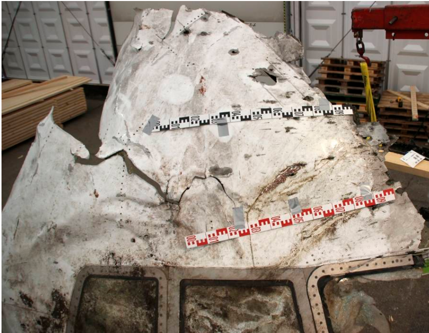
Figuur 26: Lokale richting van de schampschade aan het cockpitdak aangegeven door linialen
