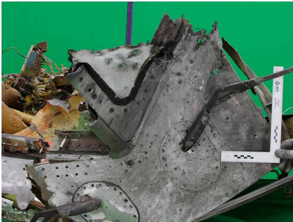
Figuur 18: Voorste hoek van de voorruit aan de linkerkant van de cockpit (Bron: OVV)
