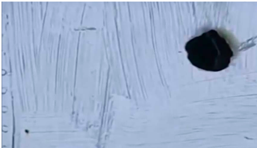
Figuur 39: Detail van GSh-30 projectielschade (Bron: YouTube)
