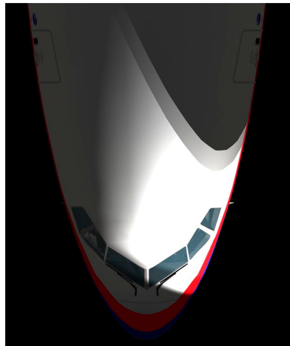
Figuur 56: Match van inslagen van de hoogenergetische objecten op het cockpit-dak
