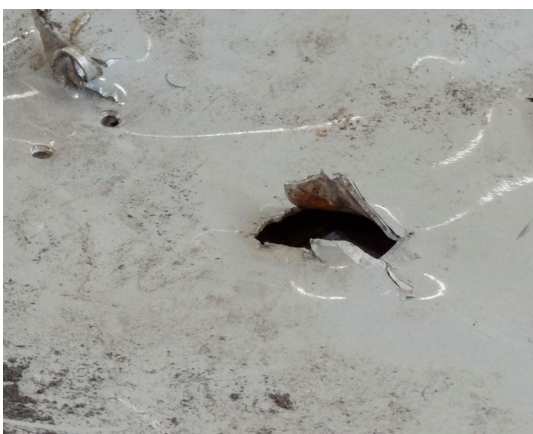
Figuur 10: Uitschotschade aan de rechteronderkant van de cockpit
