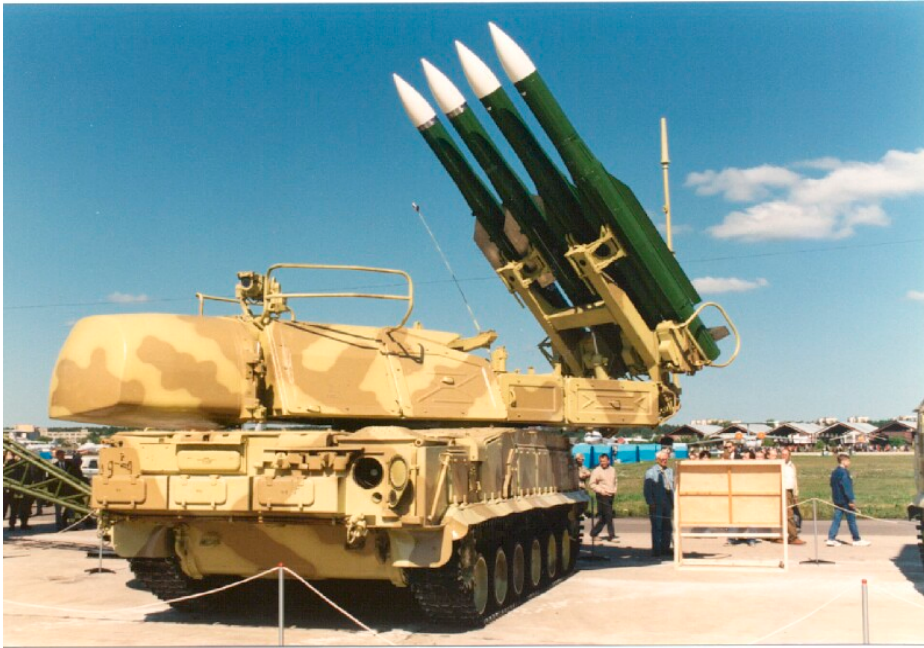
Figuur 45: BUK-M1-2 grond-lucht raketsysteem mobiele raketlanceerinrichting met radar (TELAR) 9A310M1-2 met twee 9M317 raketten (links) en twee 9M38M1 raketten (rechts)
