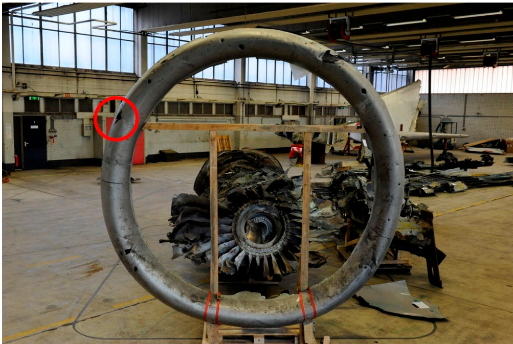
Figuur 28: Inslagschade aan de voorzijde van de ring van de motorgondel
