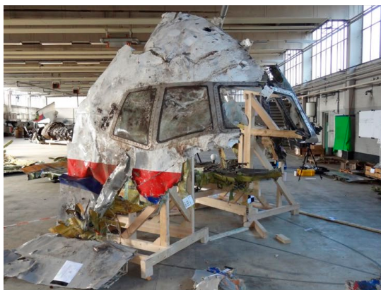
Figuur 59: Match van inslagen van de hoogenergetische objecten, vooraanzicht
