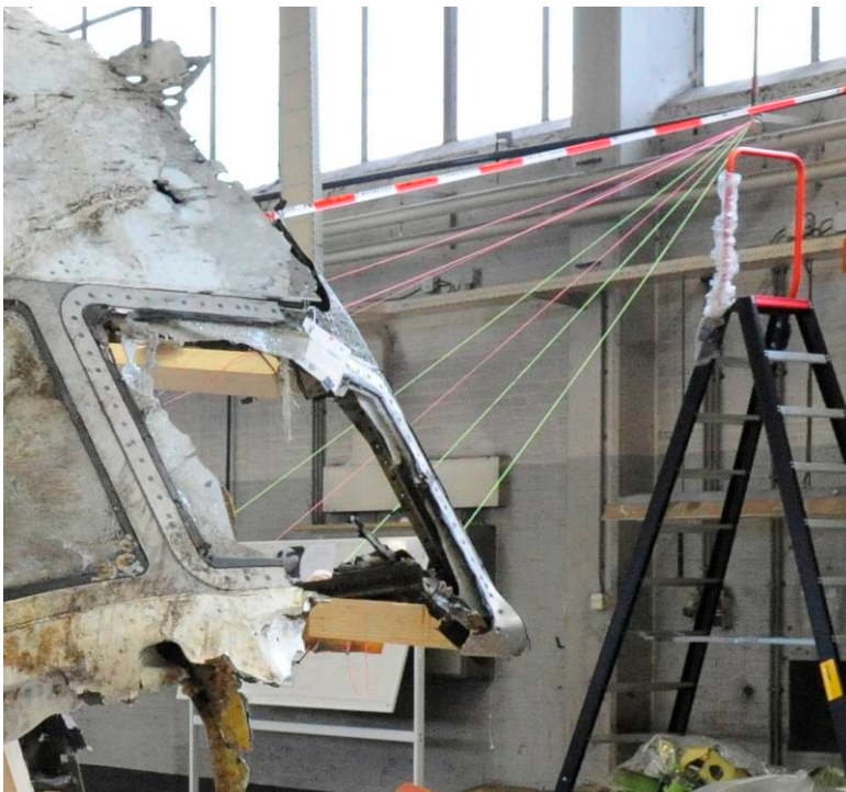
Figuur 25: Herleiden van de inslagrichting van de hoogenergetische objecten (stringing) om het algemene oorsprongsgebied te bepalen (Bron: OVV)
