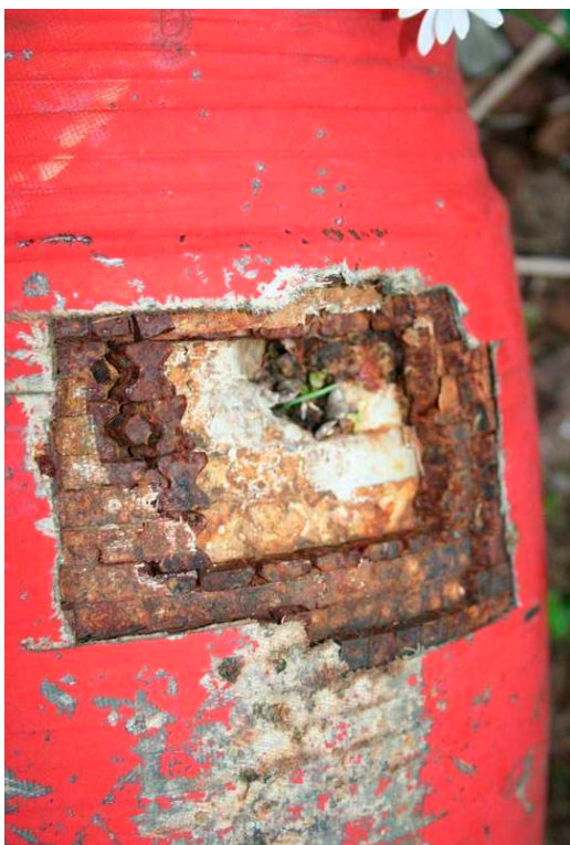
Figuur 48: Fragmentlagen in een inerte 9N314M springkop (Bron: photo.quip.ru )
