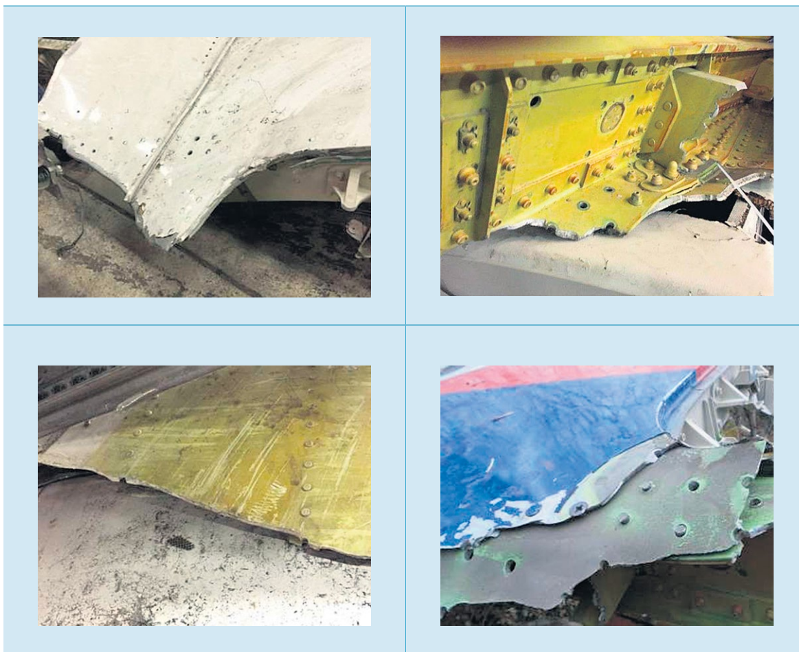
Figuur 69: Voorbeeld van breuk als gevolg van overmatige trekspanning bij passagiersdeuren 3L en 3R. (Bron: Onderzoeksraad voor Veiligheid)
