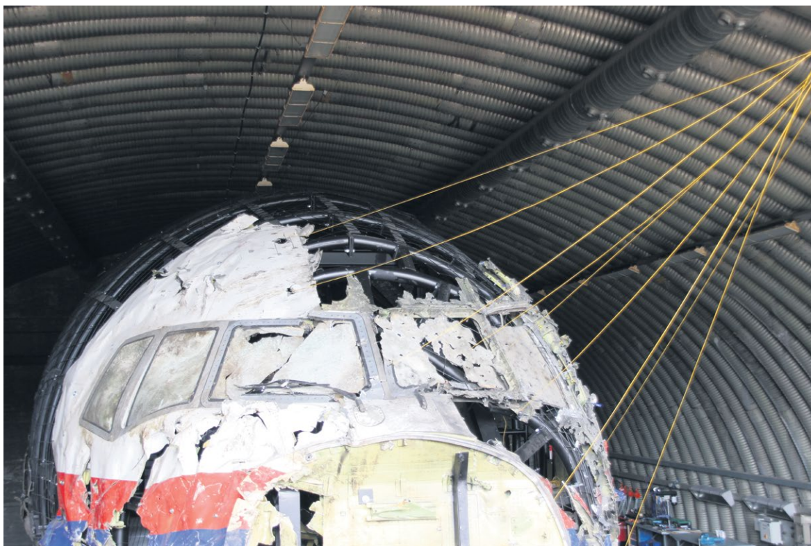
Figuur 50: Impressie van stringing van de cockpit. (Bron: Onderzoeksraad voor Veiligheid)
