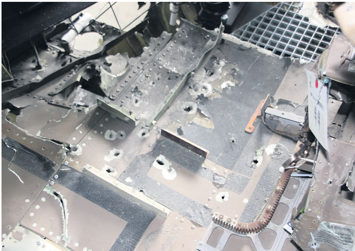
Figuur 22: Cockpitvloer met doorboringsgaten. (Bron: Onderzoeksraad voor Veiligheid)
