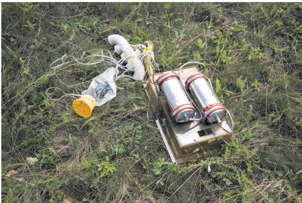
Figuur 41: Zuurstofgeneratoren en deel van passenger service unit . (Bron: Onderzoeksraad voor Veiligheid)
