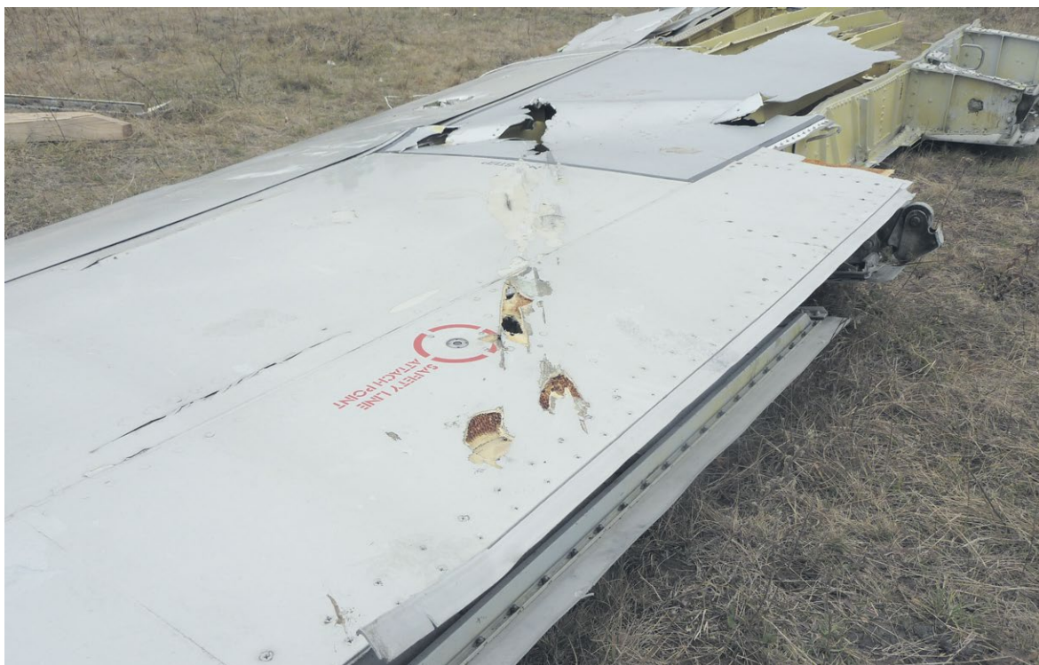
Figuur 29: Linkervleugeltip met inslagschade dichtbij en buiten het bevestigingspunt van de veiligheidslijn. (Bron: Onderzoeksraad voor Veiligheid)
