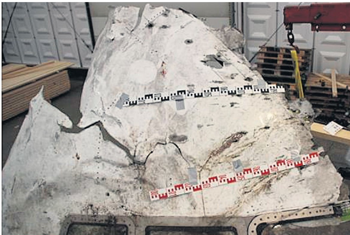
Figuur 49: Schampen op cockpitdak. (Bron: NLR)
