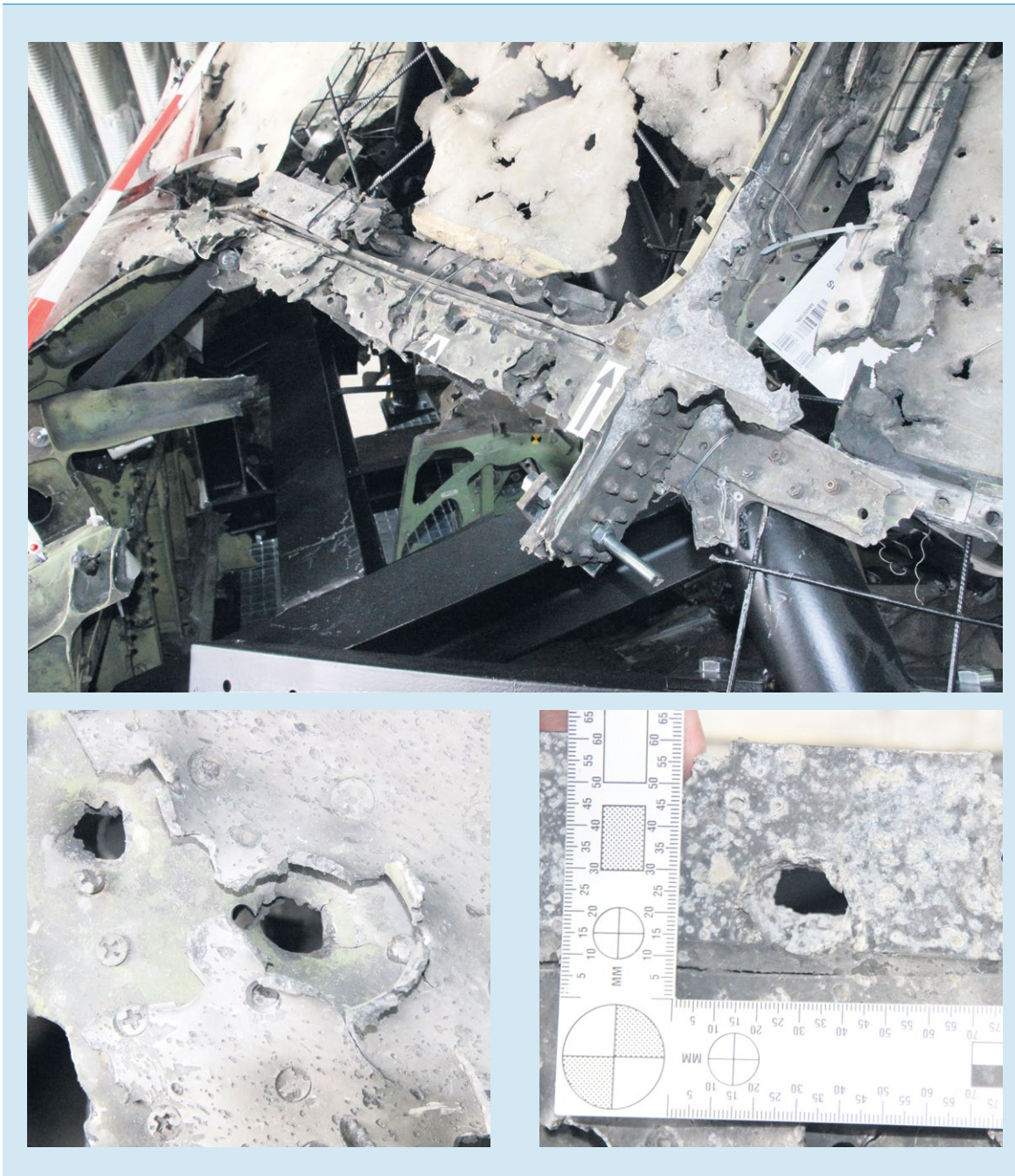
Figuur 47: Deel van het frame van het cockpitraam aan de linkerkant met een uitvergroot detail. De doorboringsschade had een regelmatig patroon van grote en kleine gaten. (Bron: Onderzoeksraad voor Veiligheid)
