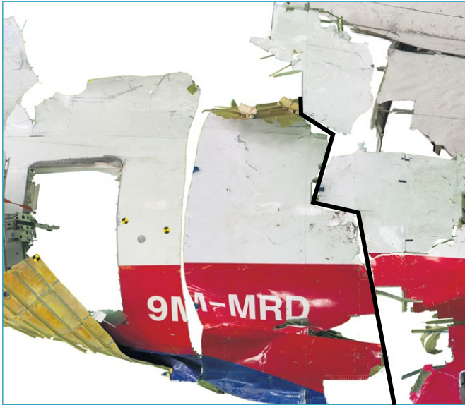
Figuur 70: Linker scheidingsbreuk tussen achterste deel van de romp en het staartdeel. Scheiding bij onregelmatige breuk aangegeven met zwarte lijn. De verticale doorsnijding door de linkerletter M is aangebracht voor transportdoeleinden. (Bron: Onderzoeksraad voor Veiligheid)
