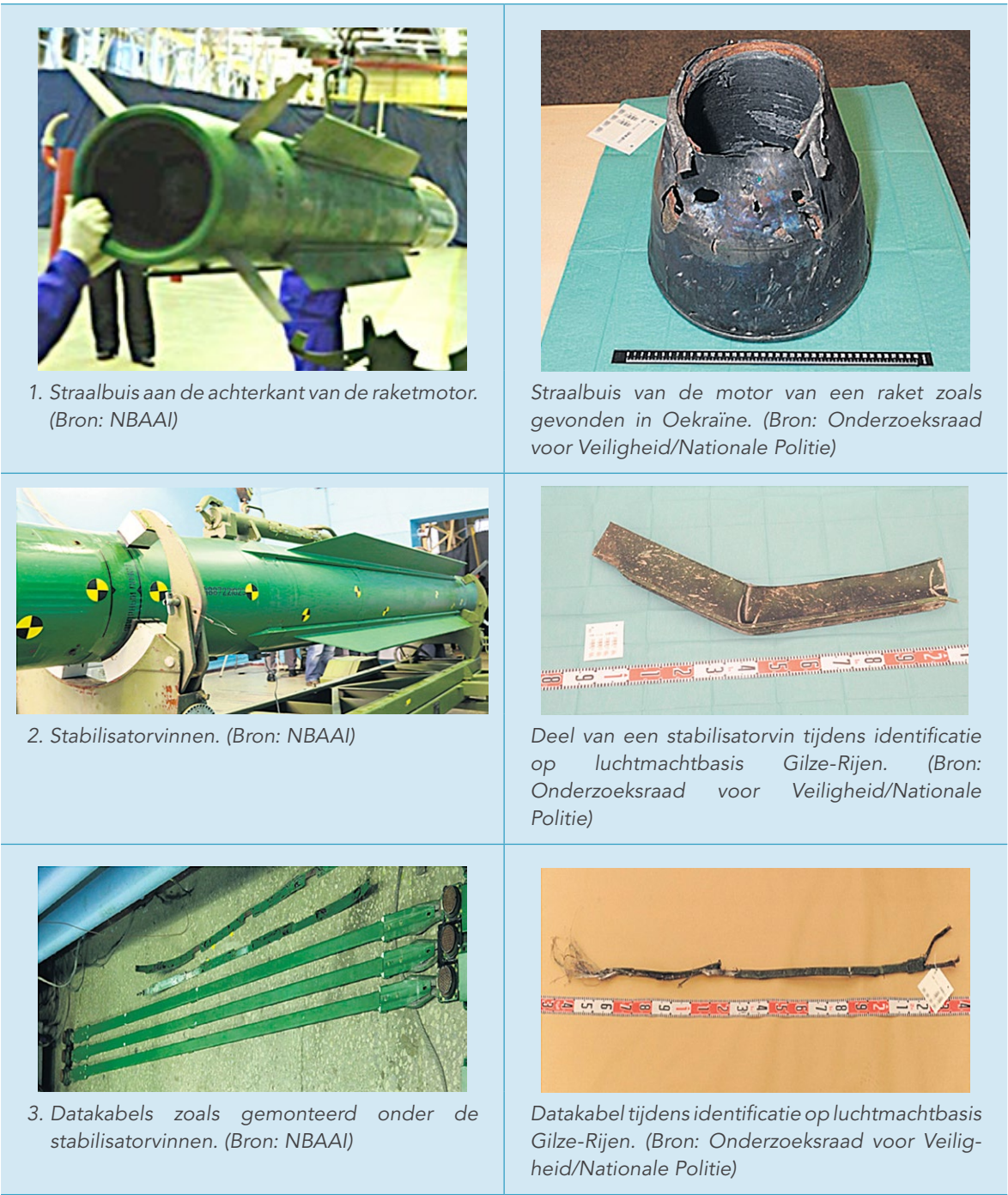
Figuur 36: Geborgen raketdelen. De delen worden getoond met voorbeeldfoto's, zodat duidelijk wordt waar ze oorspronkelijk vandaan komen op een grond-luchtraket van het model 9M38M1. Nummers komen overeen met nummers in Figuur 35.
