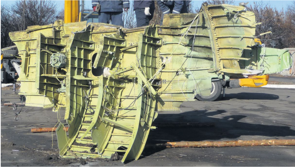
Figuur 73: Breuk die het verticale staartvlak van de romp scheidt. Aangehechte huid en gebroken verticale staartvlak-naar-rompframes, gebogen uit het vlak en met breuken. (Bron: Onderzoeksraad voor Veiligheid)
