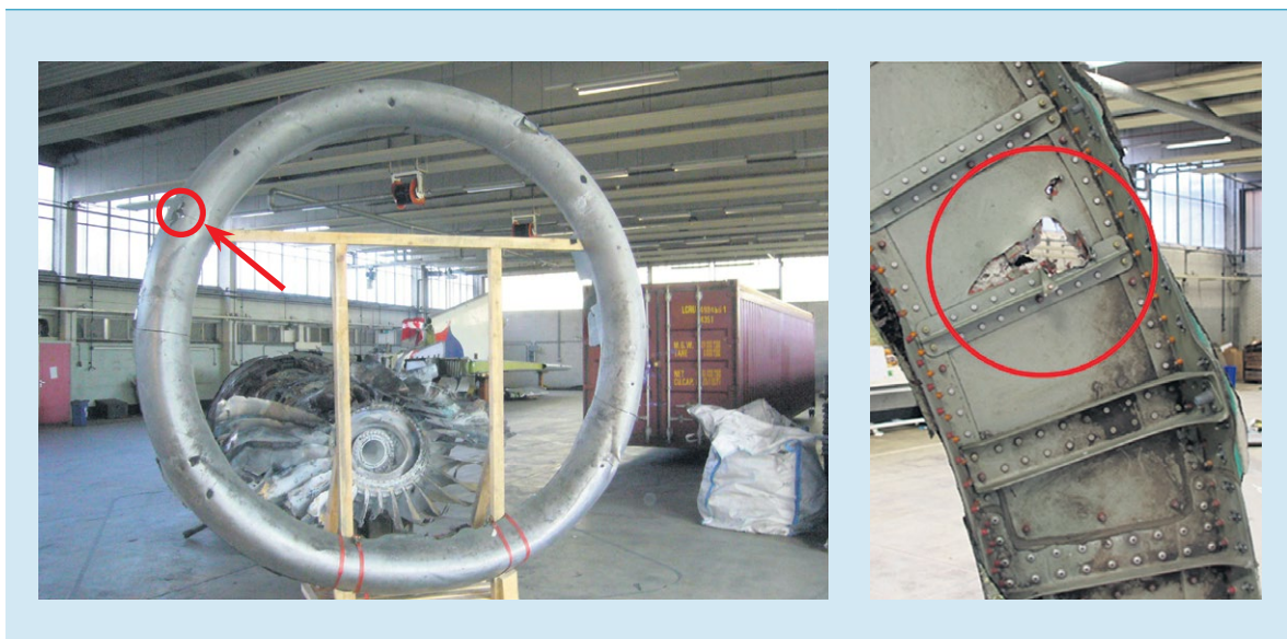
Figuur 17: Beschadigde voorrand van linkermotorinlaat, met inslagschade gezien van de voorzijde (linkerfoto) en achterzijde (rechterfoto). (Bron: Onderzoeksraad voor Veiligheid)
