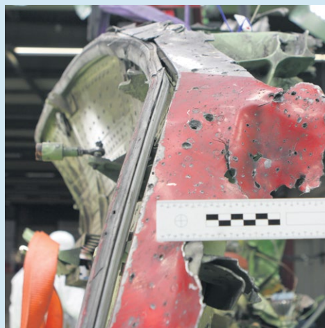
Figuur 21: Doorboringsgaten aan de linkerkant van de romp van het voorwaartse drukschot. (Bron: Onderzoeksraad voor Veiligheid)
