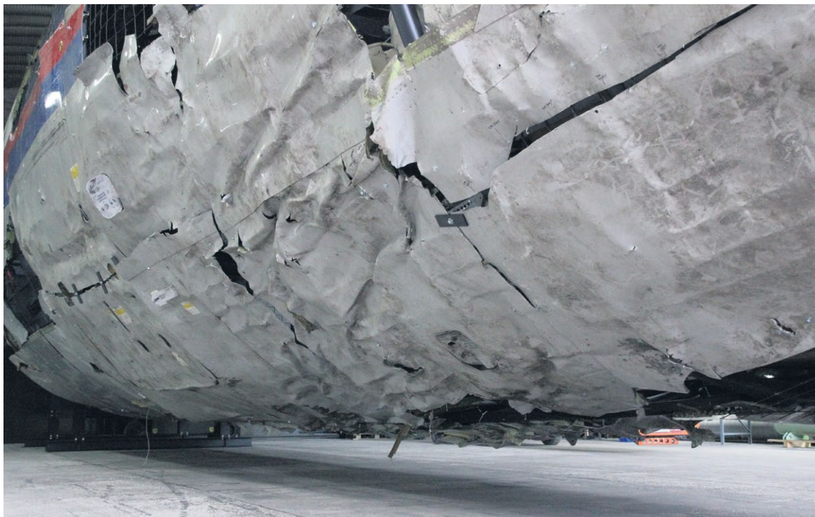
Figuur 23: Romppanelen ingedrukt tussen spanten en verstijvers. (Bron: Onderzoeksraad voor Veiligheid)
