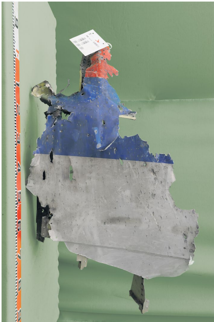
Figuur 18: Een deel van de linkerkzijde van de romp met daarin gaten en putten. (Bron: Onderzoeksraad voor Veiligheid)
