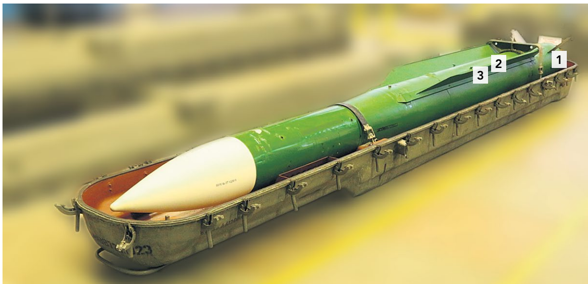
Figuur 35: Afbeelding van een grond-luchtraket van het model 9M38M1, waarop bij benadering de locatie van de drie geborgen delen is aangegeven. (Bron: NBAAI)
