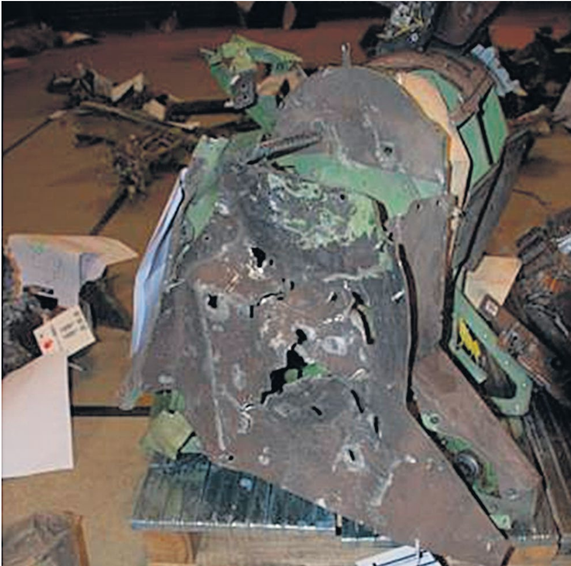
Figuur 25: Gashendelkwadrant met doorboringsschade (gezien vanaf de linkerzijde). (Bron: NLR)
