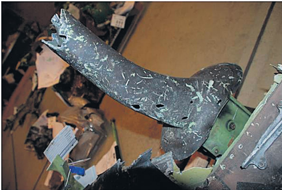
Figuur 24: Het onderste deel van de stuurkolom van de gezagvoerder met doorboringsschade. (Bron: NLR)
